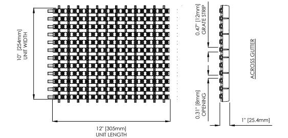
SilentFLOW DPAS: ALL COMPONENTS ARE CORROSION RESISTANT,
